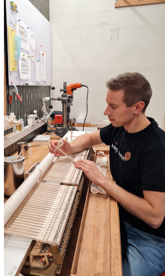
Klavierbauer Andreas Pufke bei der Ausrichtung der Hammerköpfe
